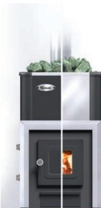
В моделях **Ермак-Элит 20-С** свод топки изготовлен из жаростойкой нержавеющей стали толщиной **3 мм** с содержанием хрома до 17% и температурой окисления до 900 °С, в топке и системе дымоходов применена нержавеющая сталь толщиной 2 мм
