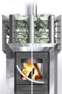
В моделях **Ермак-Элит 16-ПС/сетка** топка и система газоходов изготовлена из жаростойкой нержавеющей стали толщиной до 3 мм с содержанием хрома до 17% и температурой окисления до 900 °С
