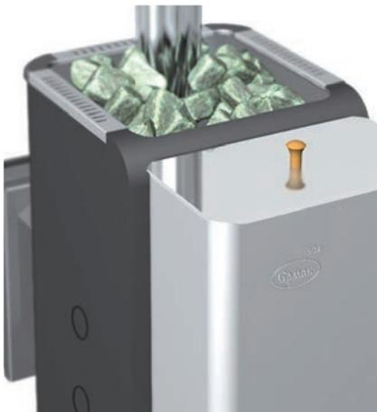
**Теплообменник**, встроенный в топку, предназначен для нагрева воды в выносном баке за счет естественной циркуляции. Удобен, когда бак для горячей воды необходимо разместить в смежном помещении (мойка). Может монтироваться на левую или правую сторону (или одновременно на обе стороны).
