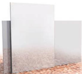
Защитный экран с базальтовым матом сокращает безопасное расстояние от печи до стен из несгораемых материалов. Является отражателем инфракрасного излучения и декорирует внутреннее пространство парилки. Стенки экрана выполнены из нержавеющей стали толщиной 0,5 мм.
