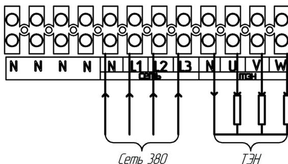
Рис. 4 Пример трехфазного подключения
