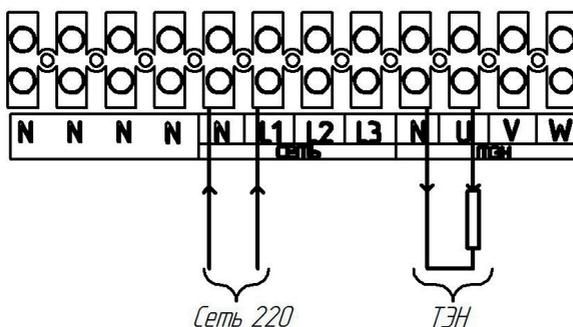
Рис. 5 Пример однофазного подключения
